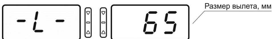
Рисунок 6.3 – Показания индикаторов во время пользования электронной линейкой для измерения дистанции (измеритель диаметра выключен)
