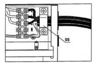
Предохранители и сетевой кабель, соответствующие 100% нагрузки установки:
