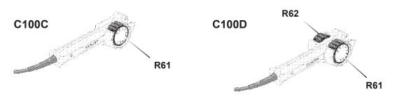
С100С Регулировка сварочного тока для штучных электродов (R61), памятная шкала 1...10. С100D Грубая регулировка сварочного тока для штучных электродов (R61), памятная шкала 1...10, тонкая регулировка +/- (R62).
