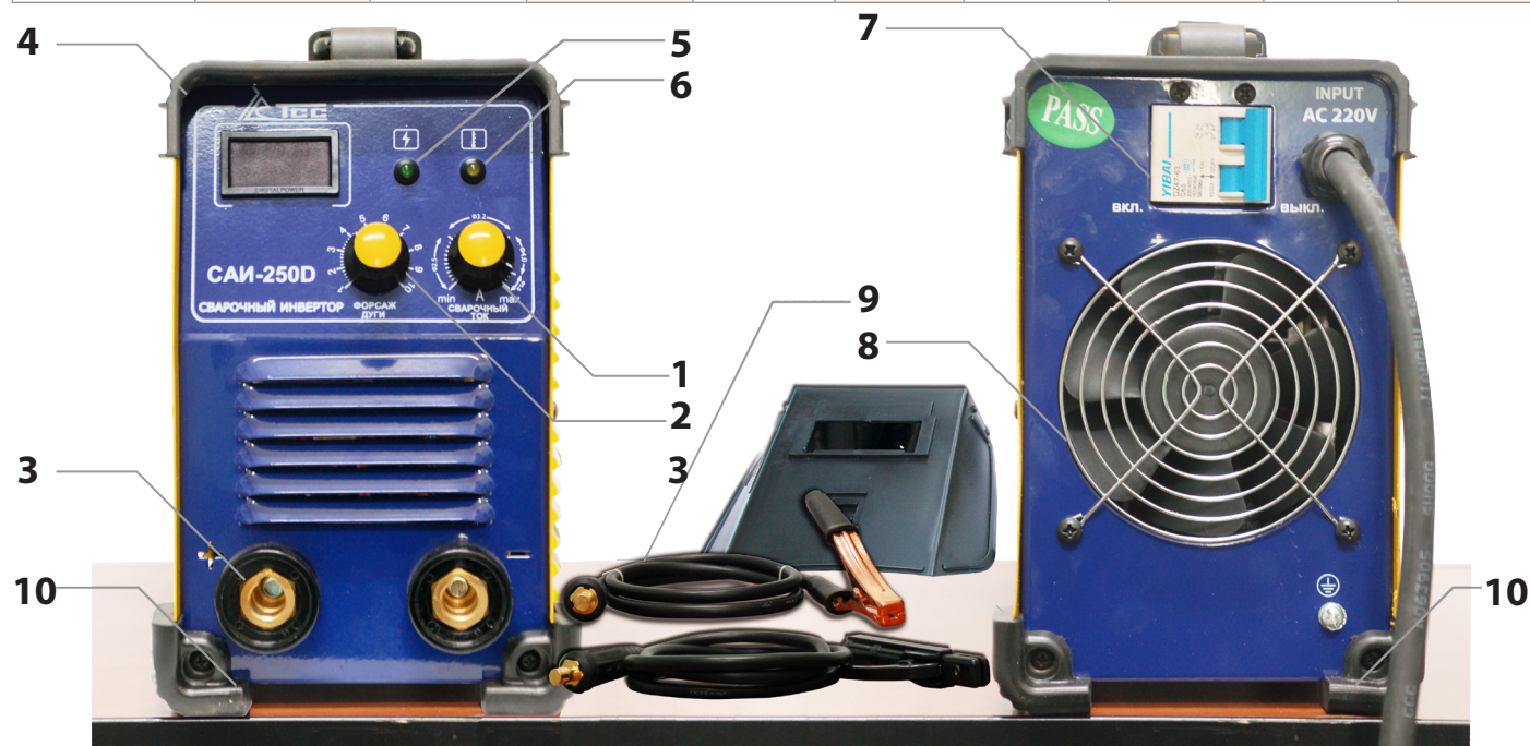
1 - регулировка сварочного тока; 2 - регулировка форсажа дуги; 3 - выводы для подключения кабеля; 4 - цифровой дисплей; 5 - индикатор сети; 6 - индикатор перегрузки; 7 - автомат защиты сети; 8 - вентилятор; 9 - кабель; 10 - прорезиненные углы.
